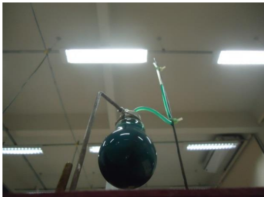
Fig. 3: Hastes metálicas de Fixação.
