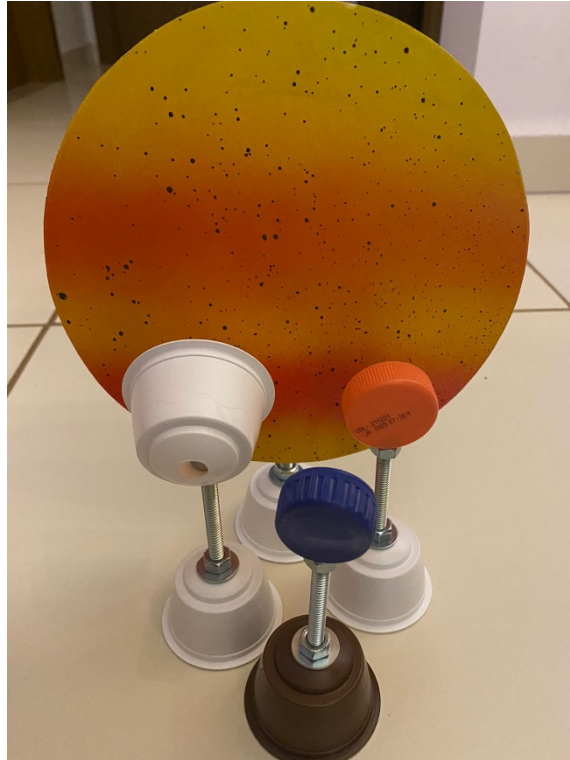
Figura 5: Conjunto construído com materiais de baixo custo onde observa-se um anteparo de 20 cm de diâmetro, mecanismo de visada e dois anteparos de 2 cm e 3 cm de diâmetro. Fonte: Elaborado pelo autor.
