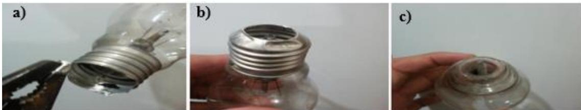
Fig. 1: Retirada do contato da lâmpada.
