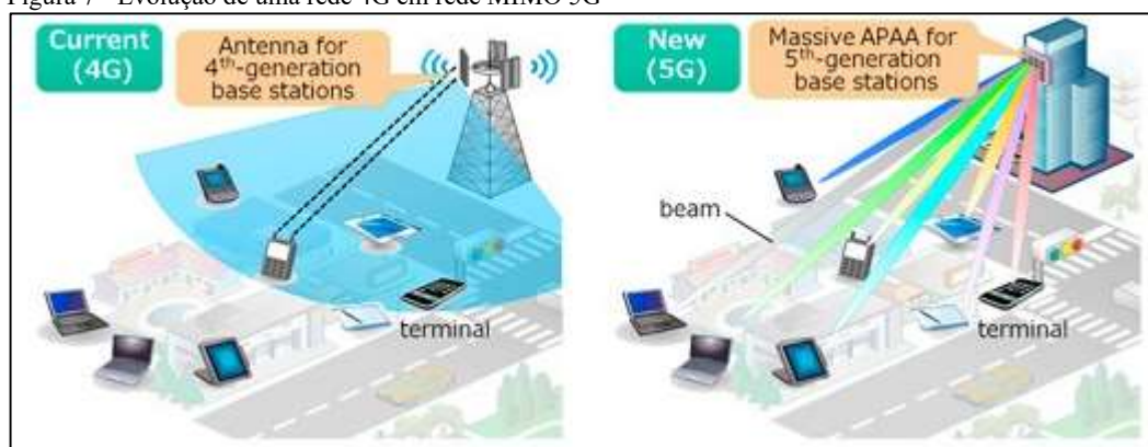
Figura 7 - Evolução de uma rede 4G em rede MIMO 5G
